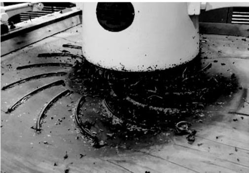
黒岩地区にある茶工場の一角で、JAコスモス茶部会の新しいチャレンジ『釜炒り一番茶』作りが始まりました。日本で流通する日本茶の95%は茶葉を蒸して作りますが、釜炒り茶は名前の通り茶葉を釜で“炒った”お茶のことです。ここ黒岩の茶工場では、小さな機械で手作業でつくられています。一度に機械に入れられる茶葉の量はたったの5kg。ガスで300度に熱せられた炒り葉機で30分炒り、半分の量に減った茶葉を揉捻機（写真）で30分揉みます。その後100度で30分間の乾燥を2回行い、完成です。午前中に摘み取った一番茶は、時間の経過とともに切り口が酸化してしまいます。新鮮なうちに商品にする為に、この日は夜遅くまで作業が行われました。できあがった釜炒り茶の色は土佐茶と同じ金色透明。釜香と呼ばれる独特の芳ばしい香りがし、すっきりとした上品な味のお茶でした。この新製品「釜炒り一番茶」は、佐川町のはちきんの店で販売中です。
