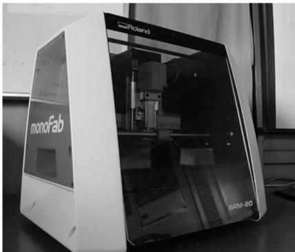
回転する刃物によって素材を切削加工する。
