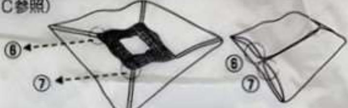
反対側も同様に合わせた後、シートの両端⑧と⑨を持ち、中央で合わせます。反対側も同様に合わせます。更に中央に折り込み、1/4のサイズにたたみます。(図・C-1、参照)
