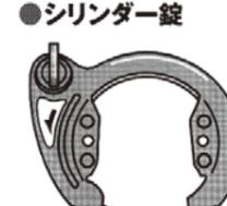
キーを差し込み、回して解錠しますが、シリンダー内が複雑な仕組みのため、工具でもこじ開けにくく盗難に強い錠前です。
